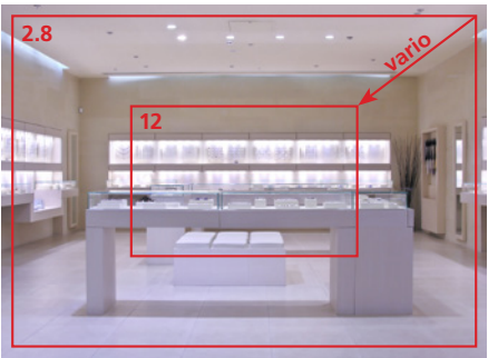
Bildausschnitte Fix- / Variokameras Détails de caméras fixes / variables
